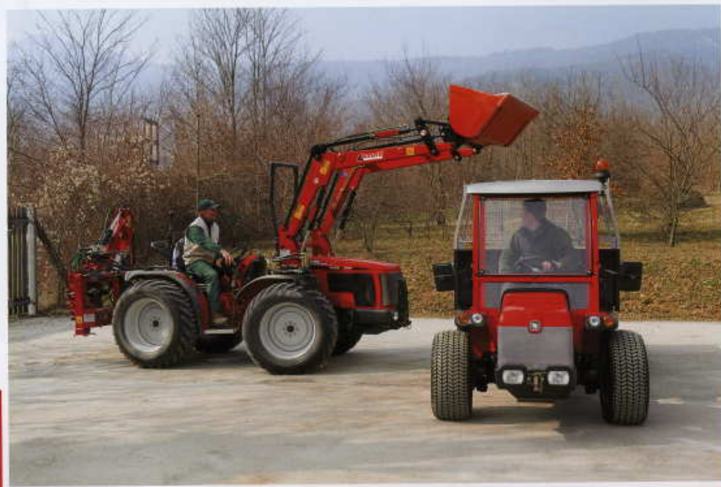
● TRH 9400 con caricatore anteriore MP3/S e retroscavatore RET 220 CITY
