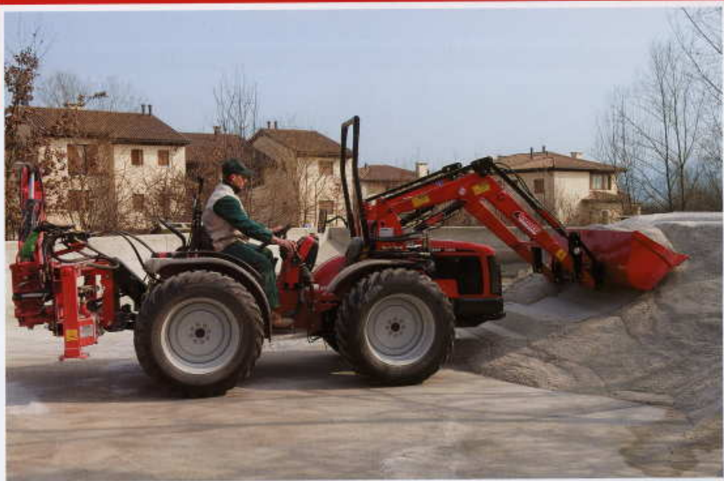
● TRH 9400 con caricatore anteriore MP3/S e retroscavatore RET 220 CITY
